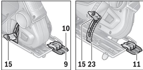
Lõikejoone kontrolliks on „Cut Control“ vaateaknal **9** märgis paremale poole kulgeva lõike jaoks tähisega 0° ja **11** märgis vasakule poole kulgeva kaldlõike jaoks tähisega 45°. Skaalal **23** on märgised 22,5, 30 ja 45°. Võimalikud on vahelõiked.
