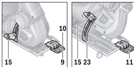
Pro kontrolu čáry řezu je na průhledu pro „Cut Control“ jedna značka **9** pro pravouhlý řez s 0° a jedna značka **11** pro pokosový řez se sklonem doleva se 45°. Na stupnici **23** najdete značky pro 22,5, 30 a 45°. Lze provádět řezy s úhly mezi těmito hodnotami.
