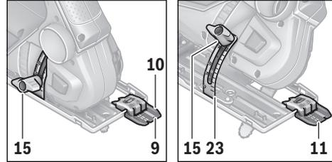
Radi kontrole linije reza na kontrolnom staklu za „Cut Control“ postoji oznaka **9** za rez pod pravim uglom od 0° i oznaka **11** za padajući rez nalevo pod kosim uglom od 45°. Na skali **23** možete pronaći oznake za 22,5, 30 i 45°. Mogući su i međurezovi.
