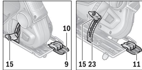
Na wzierniku systemu »Cut Control« umieszczony został znacznik **9** d cięć prostokątnych 0° oraz znacznik **11** cięć ukośnych 45°, skierowanych w lewo. Na podziątkę **23** znajdują się znaczniki dla kątów: 22,5, 30 i 45°. Możliwe są cięcia pomiędzy tymi znacznikami.
