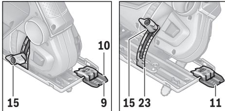
Для контролю лінії розпилювання на віконці для «Cut Control» є позначка **9** для розпилювання під прямим кутом 0° і позначка **11** для розпилювання під лівим кутом 45°. На шкалі **23** є позначки 22,5, 30 і 45°. Можливе розпилювання під проміжними кутами.
